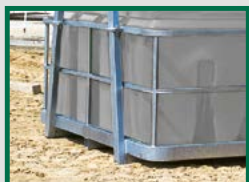
› Kovové zabezpečení nádrže
